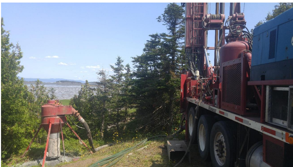
Figure 3.4-Forage du puits F-01 à Kamouraska avec une foreuse conventionnelle de type rotopercussion par la compagnie Puitbec
