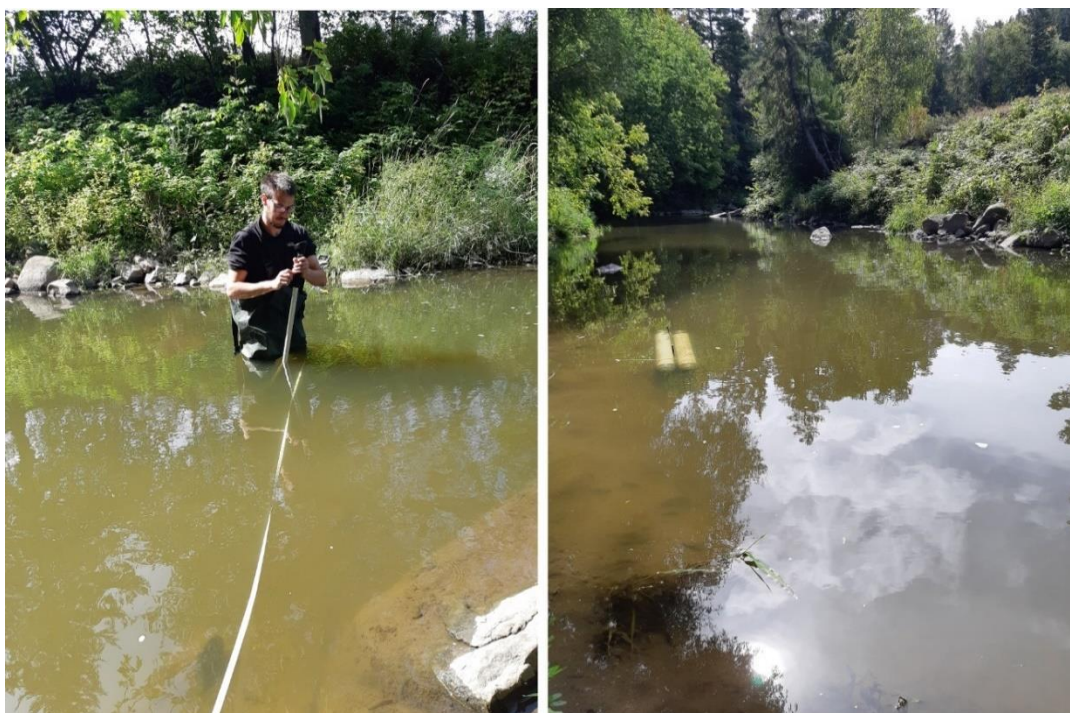
Figure 3.9-Mesure de la vitesse des courants (photo de gauche) et installation des pièges à sédiments (photo de droite) à la station Goudron.
