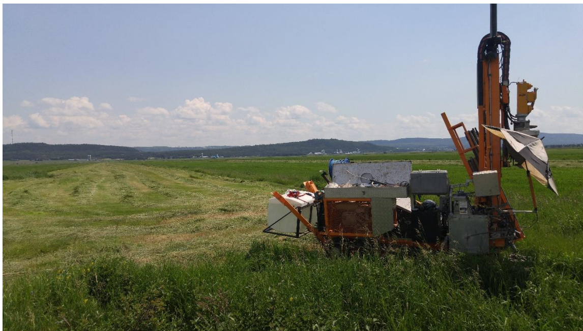
Figure 3.3-Foreuse de l'INRS lors des forages dans les dépôts meubles
