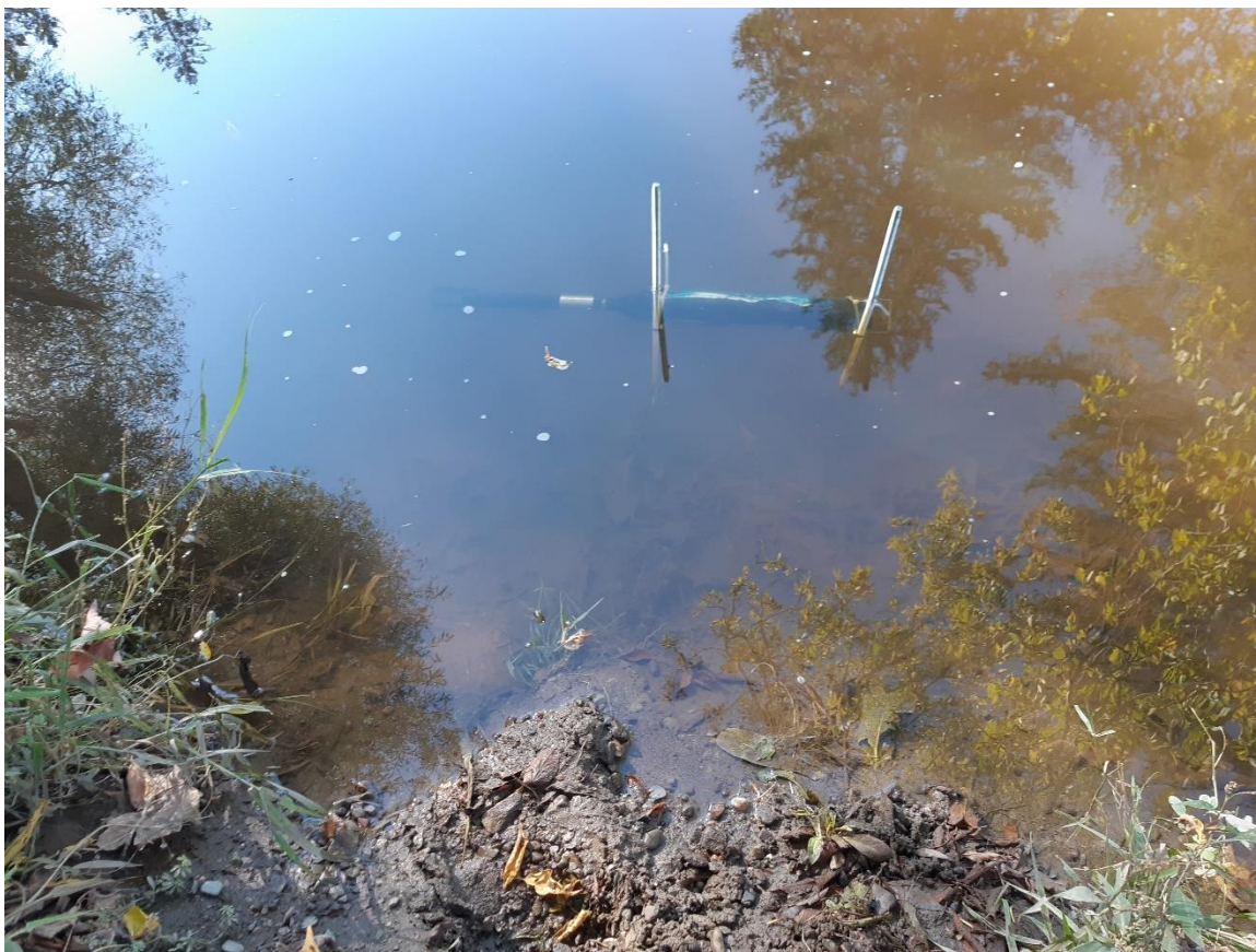
Figure 3.11-Photo du déploiement du turbidimètre NEP595 pour un test terrain dans la rivière Goudron.
