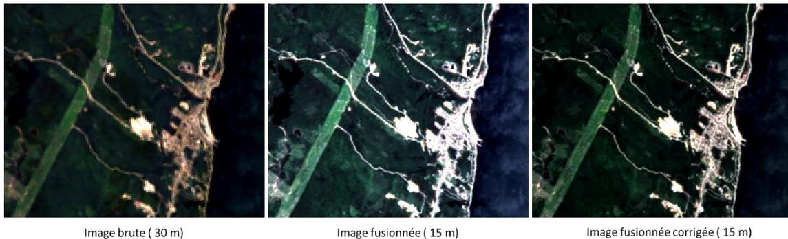
Figure 3 : Exemple de la fusion et correction d'image.
